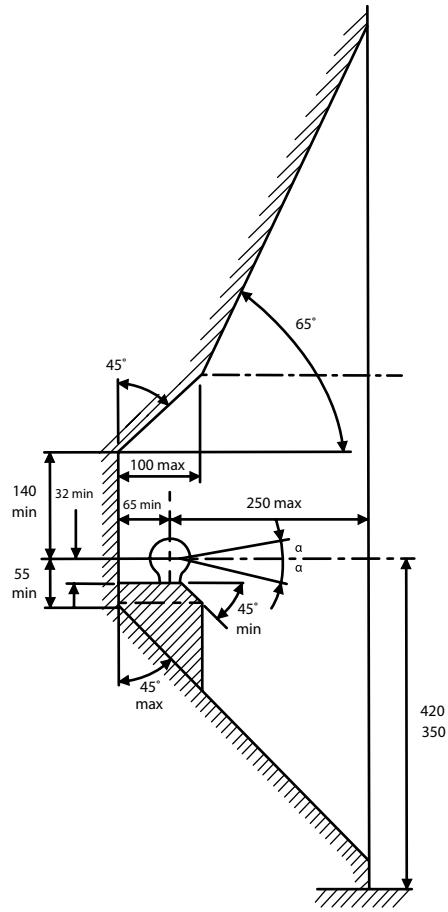
De tussenruimte conform bijlage VII, afbeelding 25 (a, b) van het reglement nr. 55-01 UN/ECE moet in acht genomen worden. Deze voorschriften zijn niet van toepassing op terreinvoertuigen klasse G.
