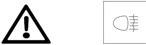
**D** Wenn die Nebelschlussleuchte am Fahrzeug eingeschaltet ist, darf der Anhänger nicht an -oder abgekuppelt werden!
